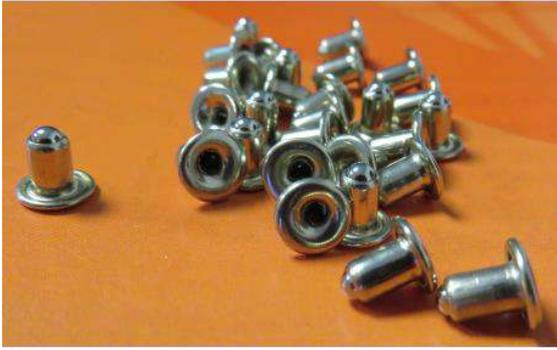
También conocidas como válvulas de descompresión o válvulas altimétricas, son elementos que se emplean en la producción de vidrio cuando la diferencia de altitud (positiva o negativa) entre el lugar de fabricación y el de montaje es mayor de 800/1000 m para dobles acristalamientos y 400/500 m para triples acristalamientos.
