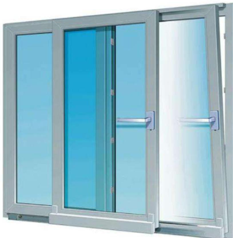
Las ventanas paralelas son aquellas en las que una de las hojas se desplaza paralelamente sobre unas guías hacia el interior de la vivienda. Es posible hablar de una ventana oscilo-paralela si a la hoja móvil además del movimiento de hoja paralela se le permite una apertura oscilobatiente.
